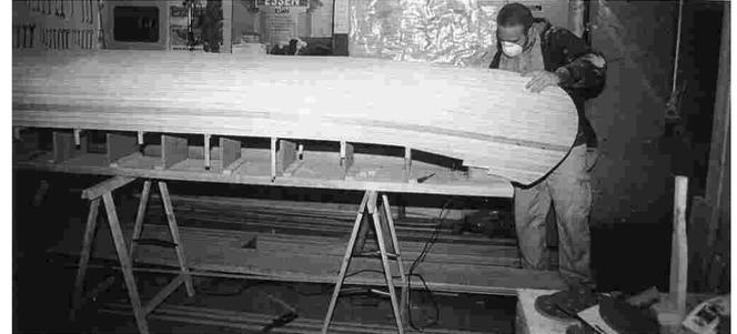
Erlern werden die Fertigkeiten, mit ein paar "Brettern und Bohlen", etwas Leim und einigen gängigen Werkzeugen ein aus Holzleisten hergestelltes Kanu zu bauen (Strip-Plank-Bauweise).
